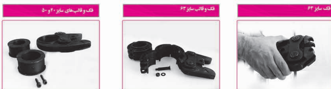
طریقه نصب فک پرس بر روی هد دستگاه
